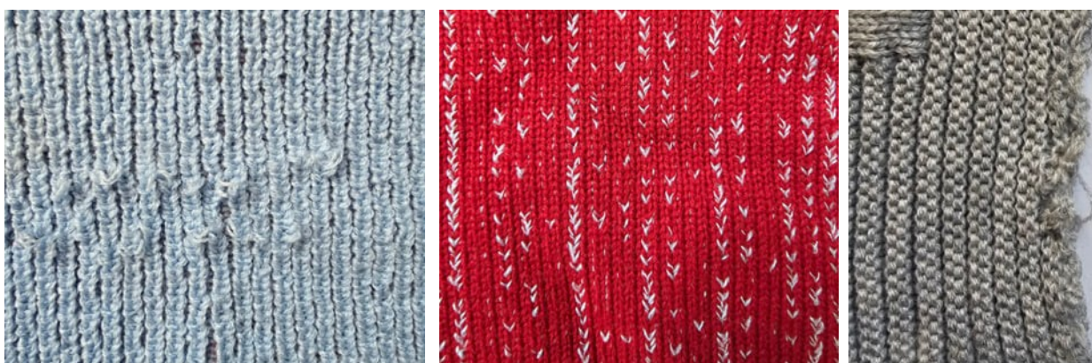
1-rasm. Trikotaj matosini ishlab chiqarishda tortish jarayonida yuzaga kelgan nuqsonlar ko'rinishi.
