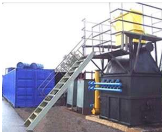
Рисунок 2 Внешний вид реактора термохимической конверсии углеродсодержащего сырья
