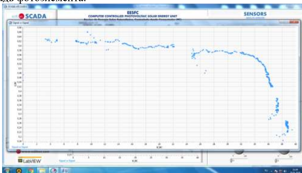
Рис. 2. ВАХ солнечного элемента, полученная с помощью системы Edibon Scada.
