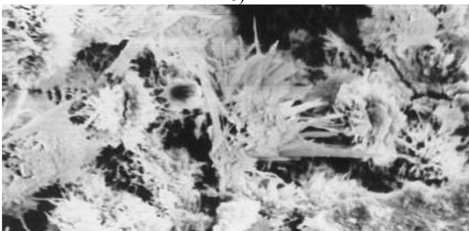
Rasm. Beton tuzilishining Mobet» materiali bilan ishlov berishdan avvalgi ( a ) va keyingi ( b ) elektron tasviri
