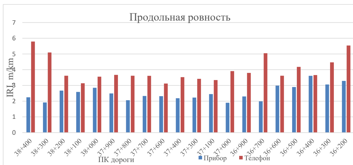
Рисунок 6. График результатов, полученных на приборе ПКР-1.[6] Преимущества и недостатки этих устройств.
