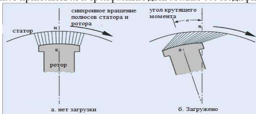
Рис: 1 Относительное положение магнитных полей статора и ротора. Скорость вращающегося магнитного поля можно получить из следующей формулы
