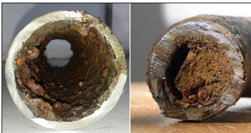
Рисунок 1.2 – Пример зарастаний и отложений в трубах.
