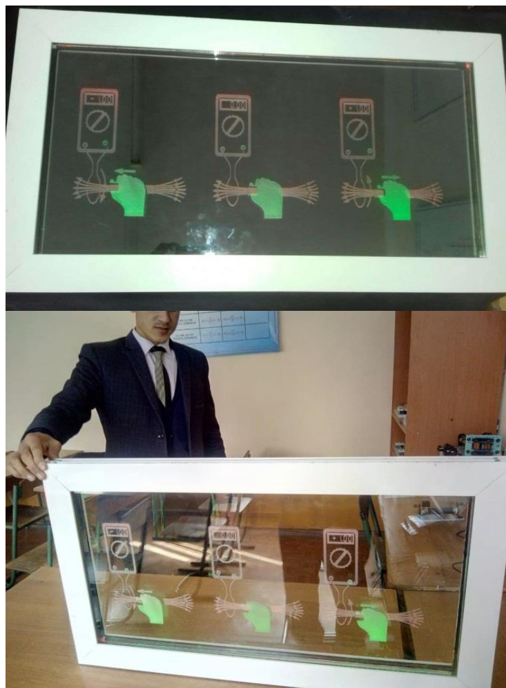
Рисунок 2. Оптическое устройство, демонстрирующее эксперимент Фарадея.
