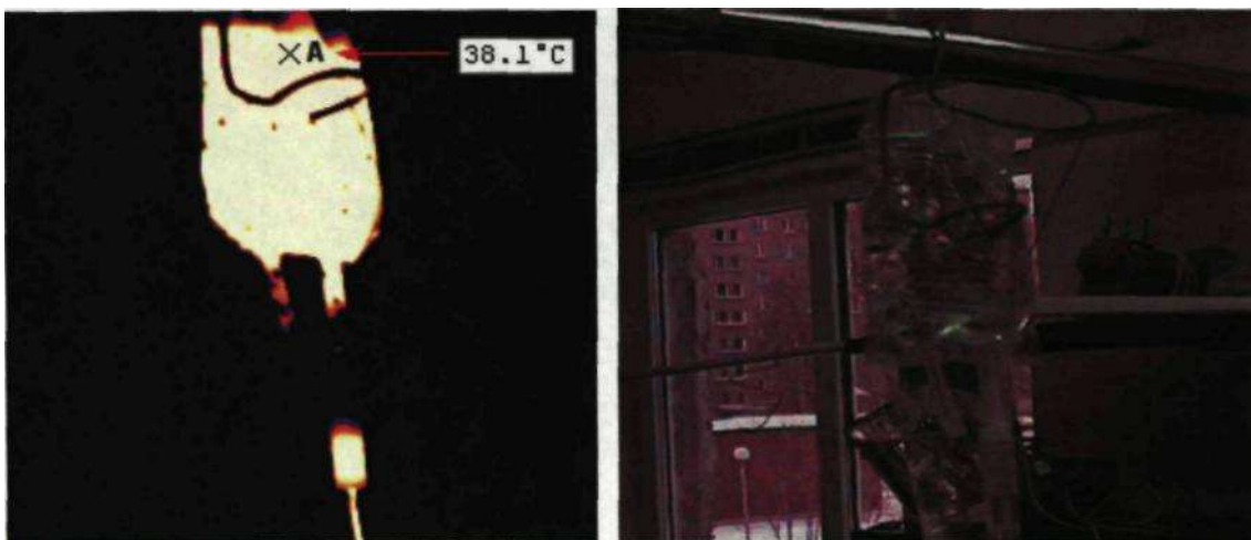
Фото 7. Снимок в инфракрасном (а) и видимом (б) диапазоне спектра излучения контейнера с раствором 0,9% натрия хлорида объемом 250 мл, предварительно подогретого до 38°C.
