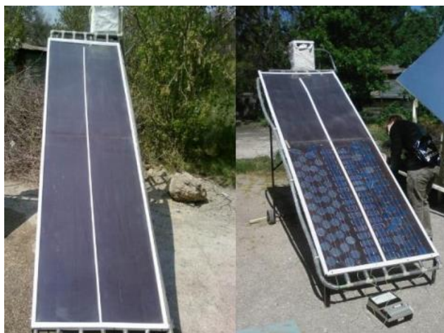
2-rasm. Quyosh issiqlik (chapda) va termo-fotoelektrik (o'ngda) qurilmalari
