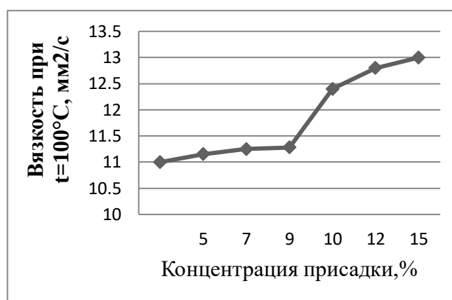
Рис 1. Изменение вязкости моторного масла для различной концентрации присадок
