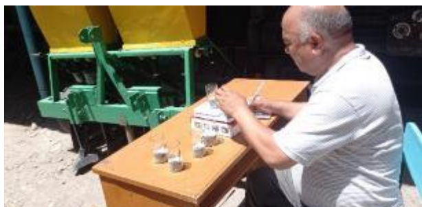
6-расм. Миқдорлагичлардан тушаётган ўғит миқдорини аниқлаш учун уларга маҳкамланганмахус идишлар (а) ва идишларга тушган ўғитни оғирлигини тортиб аниқлаш (б) услуги
