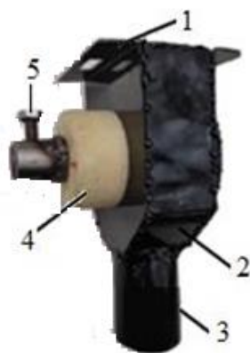
4-расм. Таклиф этилаётган ўғит тақсимловчи ғалтаксимон микдорлагич
