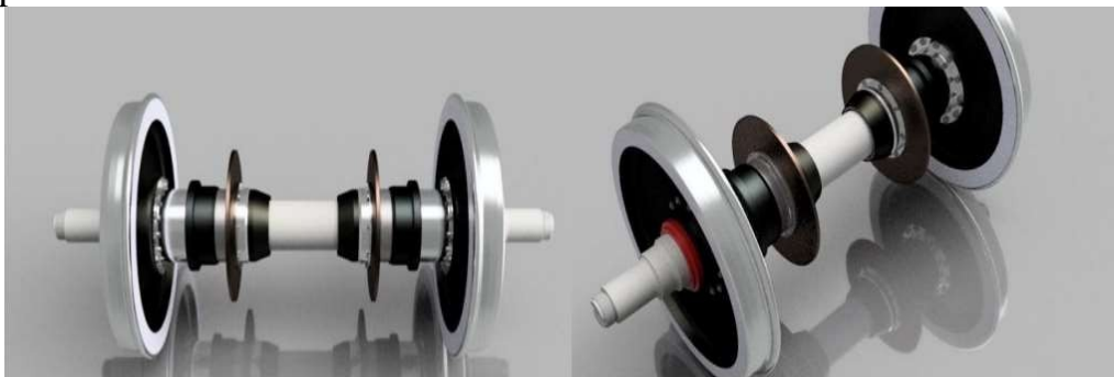
1- rasm. 3D modeli yo‘l kengligiga moslashuvchi temir yo‘l g‘ildirak juftligi
