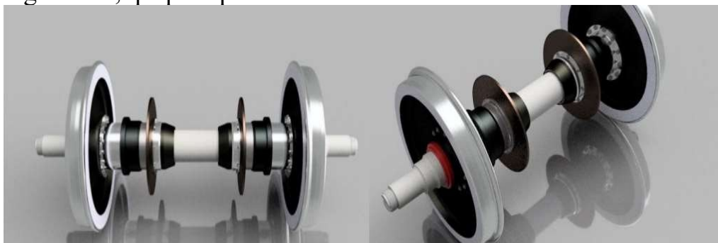
1- rasm. 3D modeli yoʻl kengligiga moslashuvchi temir yoʻl gʻildirak juftligi
