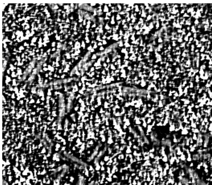
Рис.2. Электронномикроскопические снимки стекла состава 7Б, термообработанного при 1000°C, выдержка 1 ч. ×6000
