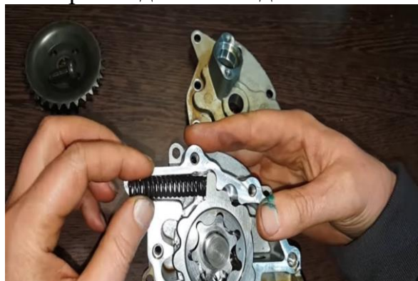
Рисунок 6. Ремонт масляного насоса
