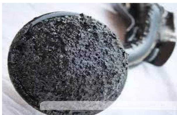
Рисунок 7. Забитая сеточка масляного насоса
