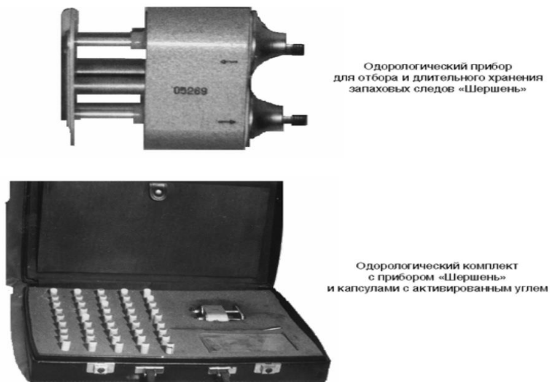
Рисунок 1 – Прибор для отбора и хранения запаховых следов «Шершень»
