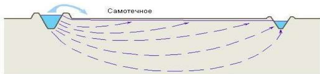
Рис. 1 Пути движения грунтовых вод в различных условиях подвода оросительной воды и отвода грунтовой ( а – случай заглубленных каналов и механического подъёма воды, б – при самотёчной водоподаче и работающей коллекторно-дренажной сети, в – при самотёчной водоподаче и затруднённом оттоке дренажно-сбросных стоков).
