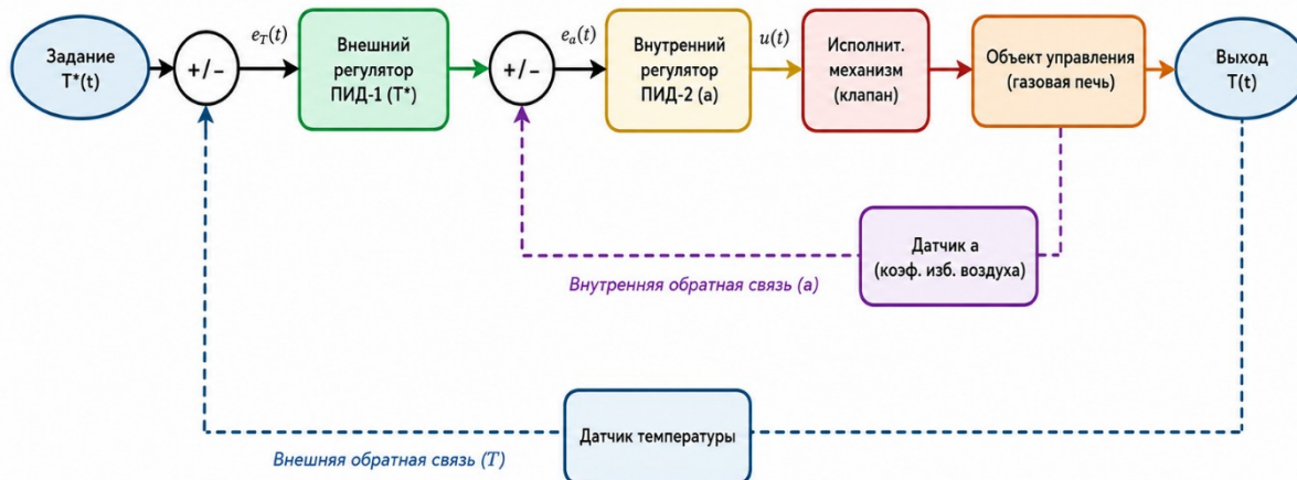
Рисунок 1. Структурная схема каскадной системы автоматического управления газовой печью
