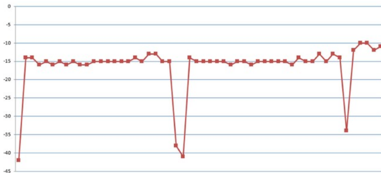
Рис. 5. Общая деформация верхнего бьефа за длительный период наблюдений (2025 год)
